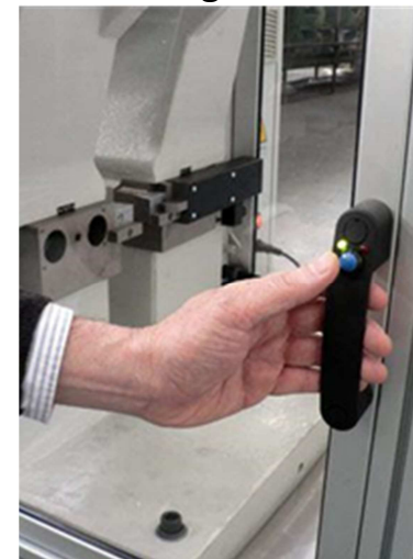
Hammerauslösung beim Schließen der Schutztür per Druckknopf am Griff
