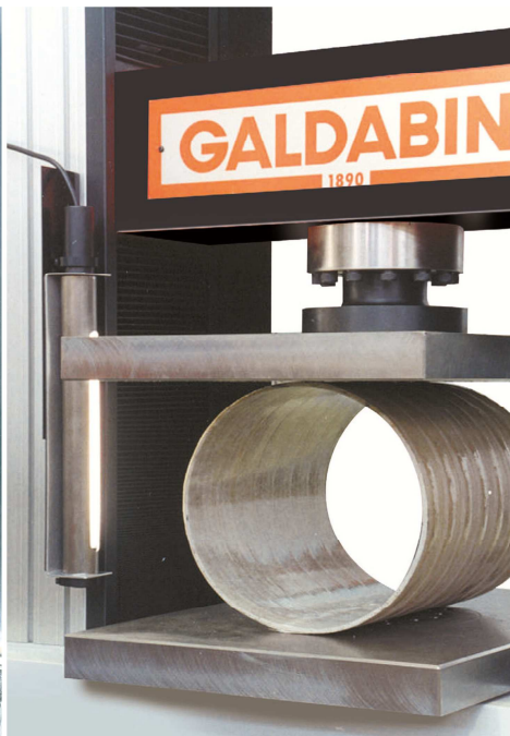
Essais de pression au sommet sur tubes
