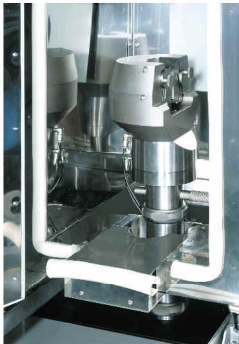
Essai thermique de traction
