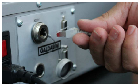
PC-Anbindung über EtherCat Hochgeschwindigkeits-Kommunikation
