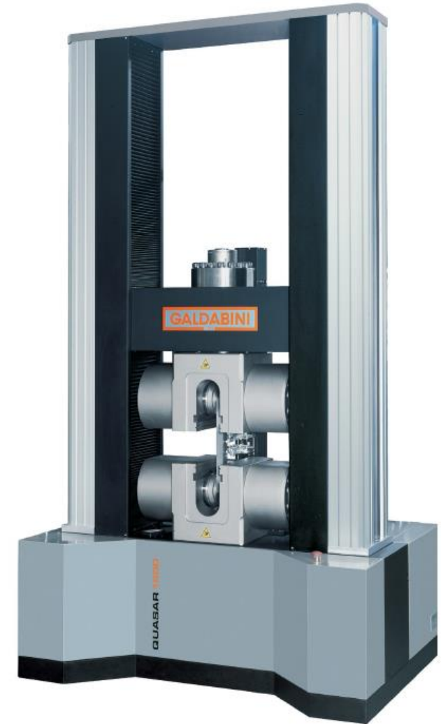
QUASAR 1200 kN Optionen: Hydraulisches Parallelspannzeug und Extensometer MICRON
