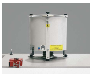
Zentrifugalabscheider erhöht die Sicht im Trennraum
