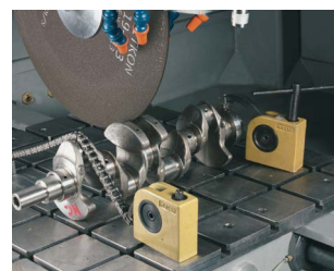
Extra großer Trennraum mit optimalem Zugang für einfache Handhabung.
