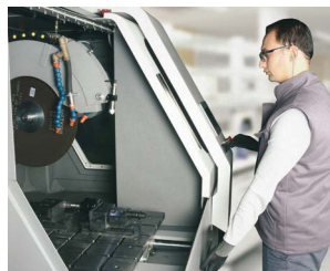
Zweihandbedienung für sicheres Arbeiten
