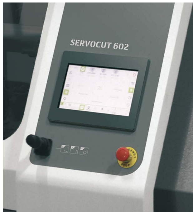
LCD Touchscreen-Bedienung mit verschiedenen Trennmethode, Datenbank mit Trennprogrammen und Wartungs-Überwachung bzw. Informationen
