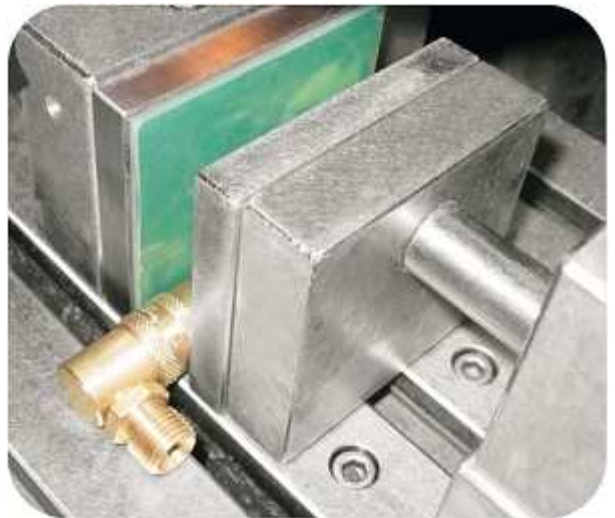
Gummi-Wechselbacken mit Messingschnellkupplung
