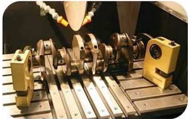
Flexible Vertikalspanner für große und schwierige Teile
