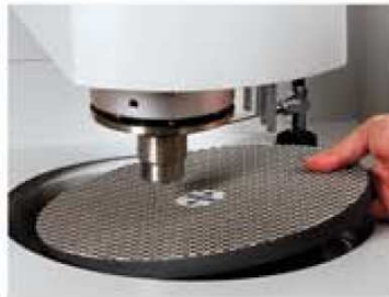
einfach wechselbare Diamantschleifscheiben
