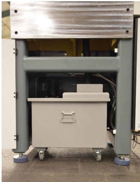
Die Maschine ist auf einem äußerst massiven Untergestell verschraubt. In diesem Untergestell ist ein 60 Liter Umlauf-Kühlsystem untergebracht. Die Höhenzustellung (einmalig beim Einrichten) ist durch eine sehr massive Graphit-Selbstschmier-Linearführung geführt. Die Zustellspindel ist gegen Spritzwasser und Frässpäne durch ein Schmutz-Rollos geschützt. Die Steuerung ist in einer separaten Elektrokiste verbaut. Die Bedienung ist, nachdem die Maschine einmalig eingerichtet ist, denkbar einfach:
