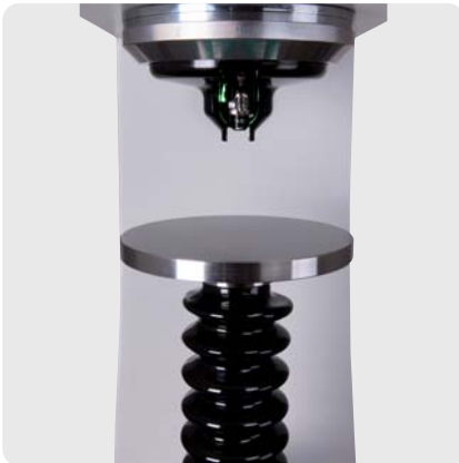
NEXUS 7500 mit (optionalem) Prüftisch ø200mm.
