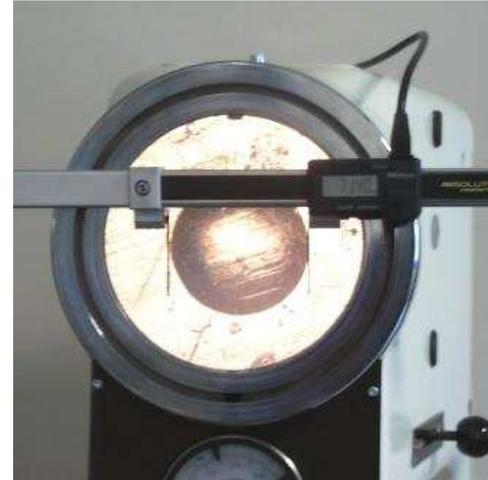
Das System SHP150 ist so konzipiert, dass der alte Maßstab (Lineal) nur gegen das neue System ausgewechselt wird. Das vorhandene Befestigungssystem des Maßstabs (Nutmasteine) wird weiterhin verwendet. Der Anschluss an den PC kann über USB-Adapter oder eine serielle Schnittstelle erfolgen. Die Inbetriebnahme des Systems ist eigenständig ohne kostspielige Anreise eines Servicetechnikers möglich.
