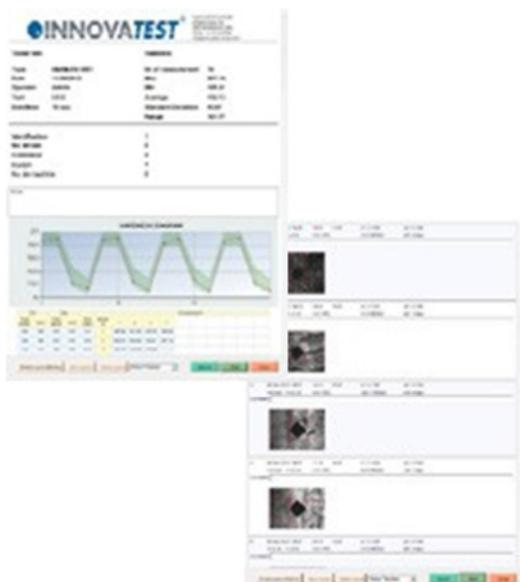
Das IMPRESSIONS™ - System beinhaltet einen sehr fortgeschrittenen Prüfberichtsgenerator. Der Prüfberichtsgenerator ermöglicht es Ihnen, alle Testergebnisse und Grafiken zu drucken, einschließlich der Prüfeindrücke. Sie können Ihre Unternehmensdaten. Ein Logo und Prüfstückrelevante Informationen hinzufügen und den Prüfbericht nach Ihren Anforderungen ändern.
